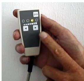
Durch Betätigen der Pfeiltasten kann der Druck zur jeder Zeit verändert werden. Anzeige der ausgewählten Druckstufe über Leuchtdioden.
