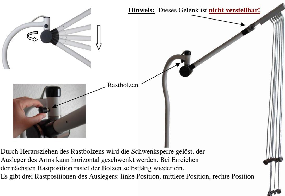
Durch Herausziehen des Rastbolzens wird die Schwenksperre gelöst, der Ausleger des Arms kann horizontal geschwenkt werden. Bei Erreichen der nächsten Rastposition rastet der Bolzen selbsttätig wieder ein. Es gibt drei Rastpositionen des Auslegers: linke Position, mittlere Position, rechte Position
