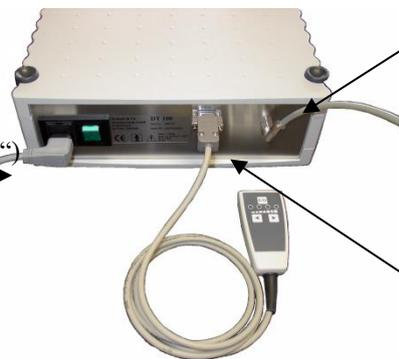
Vakuumschlauch einstecken (Bei einem eventuellen Entfernen des Vakuumschlauches muss der Ring des Winkelanschlusses zurückgedrückt werden, damit sich der Schlauch herausziehen lässt!)
