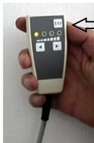
Durch erneutes Betätigen der I/O-Taste wird der Unterdruck abgeschaltet. Anschließend wird automatisch ausgeblasen.
